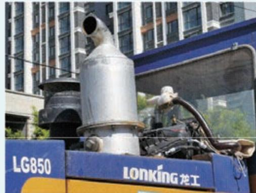
圖：施工現場減排裝置—「空氣能」及「尾氣淨化裝置」
